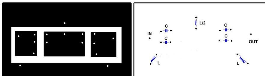
Le montage doit être mis dans une boîte métallique, les selfs doivent être montées « non parallèle » pour éviter les accrochages.
