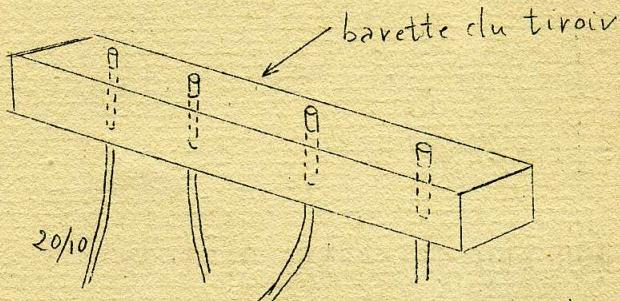
Remarquez - (Voir détail B, ressorts de contact) de la figure CQ8 page 2/5) que les différentes réglettes de plexi sont décalées en hauteur pour permettre l'enfoncement aisément du tiroir. Demaine sur le chassis du Rx - les trimers sont des 3/30 cloche Philips. Sur certaines gammes, il est schématisé par un cercle noir à la demande en vue de l'étalement
