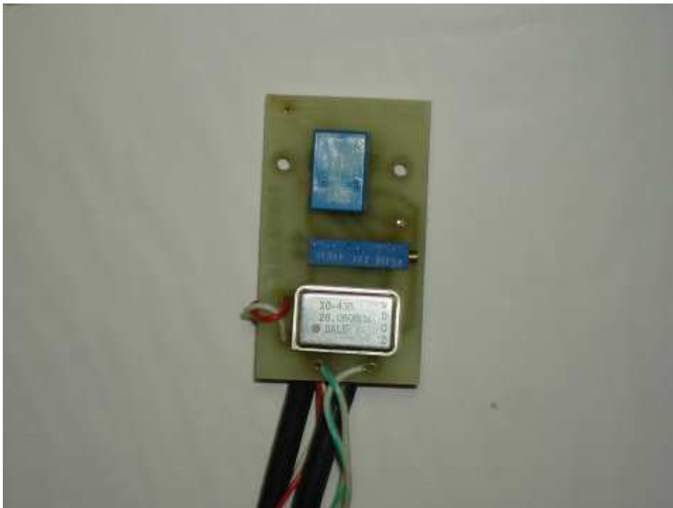
Un émetteur 10 mw cw de F8ldx
